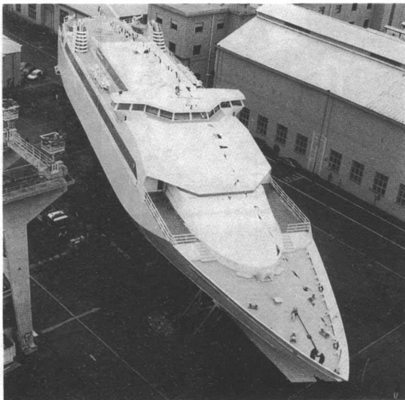
Il traghetto veloce "Pegasus", in grado di trasportare 800 passeggeri, 170 automobili e 33 autocarri ad una velocità di circa 40 nodi.
