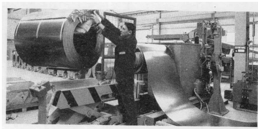
Produzione di lamelle per nucleo di trasformatori di potenza alla Electrotermica di Terni.
